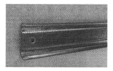
Les baguettes ont 1-1/2" x 3/8" x 8' .034". Elles servent à fixer deux panneaux de styrofoam. Elles sont trouées @ 6" c/c pour faciliter leur installation.
